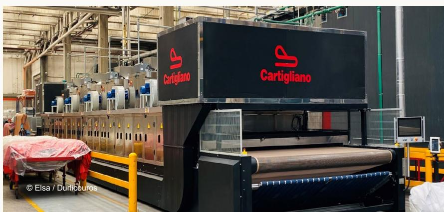
⟳ Secadora de radiofrequência (unidade México): garante couro com umidade equilibrada, maciez superior e secagem homogênea
