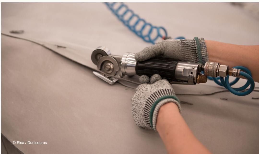
⇨ Corte das bordas do couro semiacabado para assegurar uniformidade e preparar o material para as próximas etapas de acabamento
