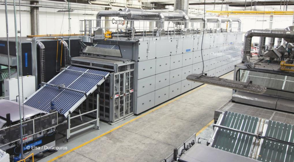
→ Secadora TAIC (unidade México): sistema de secagem com aquecimento e irradiação controlados, que proporciona couro uniforme, reduz o tempo de processamento e melhora a textura
