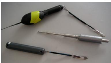
**Fig 11:** Etiquetas satelitales desmontables con etiquetas para dardos y fijación de agujas para poste. (Fuente: Juerg Brunnschweiler)
