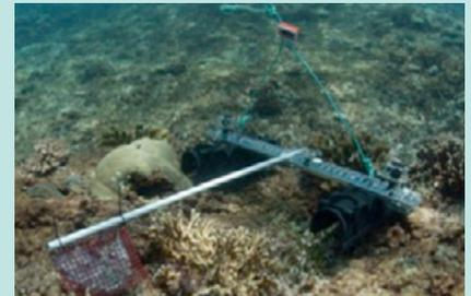
**Fig 4:** BRUVS acrílicos con una cámara dentro de cada tubo de drenaje de plástico. (Fuente: Vanessa Jaiteh)
