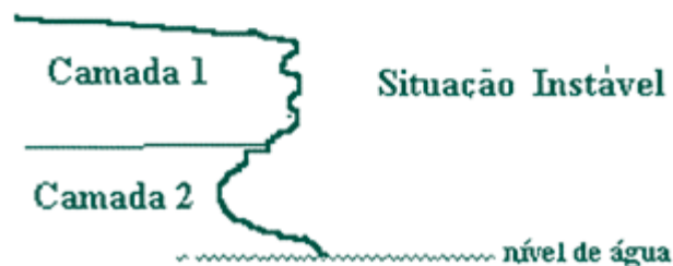
FIGURAS 5.2 E 5.3: CONFIGURAÇÕES DOS DIQUES MARGINAIS, ESTABILIDADE E DESMORONAMENTO
