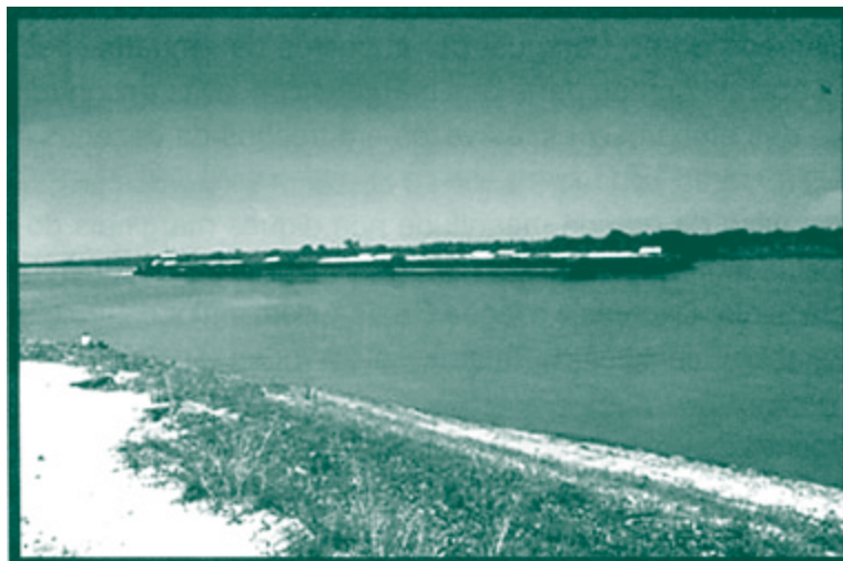
FOTOGRAFIA 6.1: COMBOIO COM 20 (5 X 4) BARCAÇAS PASSANDO EM PORTO MURTINHO, DIA 14.11.99
