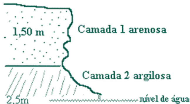
FIGURA 6.2: EROSIÃO NA CAMADA INFERIOR LEVA AO DESMORONAMENTO DA SUPERIOR
