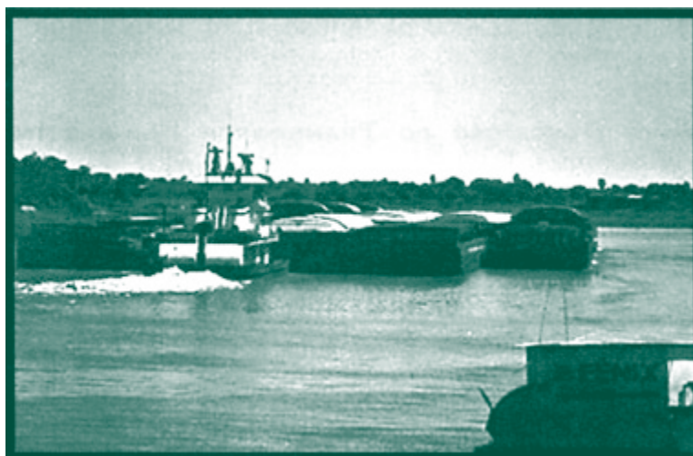
FOTOGRAFIA 6.2: COMBOIO COM 20 (5 X 4) BARCAÇAS PASSANDO EM PORTO MURTINHO, DIA 14.11.99
