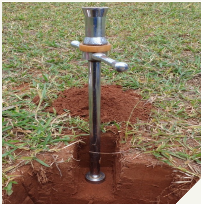
Figura 6. Trado coletor de amostras indeformadas (utilizando anel volumétrico) para determinação da densidade do solo.
