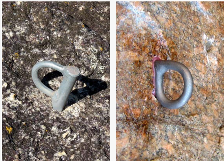
Grampos de aço (à esquerda) e de titânio (à direita)
