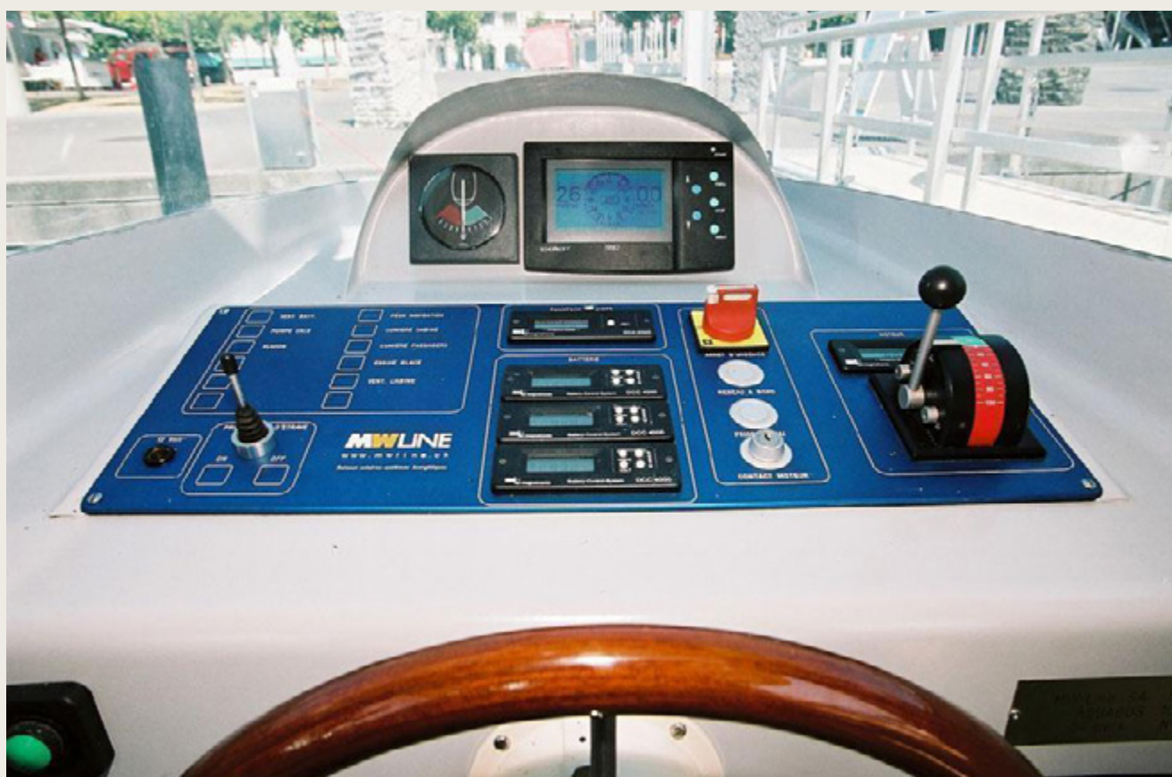
FIGURA 42 Cabine e painel de comando do Aquabus 1050
