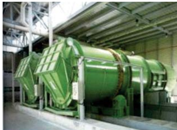
Figura 18: Sistemas de compostagem em túneis (Marseille, França) e em reatores rotativos (Maiorca, Espanha).
