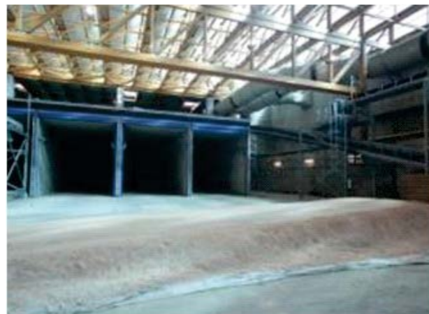
Figura 18: Sistemas de compostagem em túneis (Marseille, França) e em reatores rotativos (Maiorca, Espanha).
