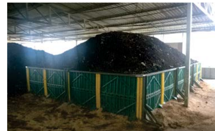
Figura 20: Processo de compostagem com aeração mista, Earthgreen (Colômbia).
