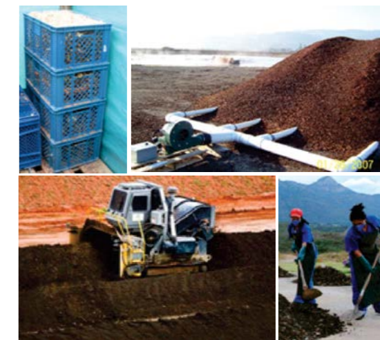
Figura 12: Processos de aeração na compostagem (Acodal Noroocidente, Acodal Noroocidente, Geociclo, PM Catas Altas)
