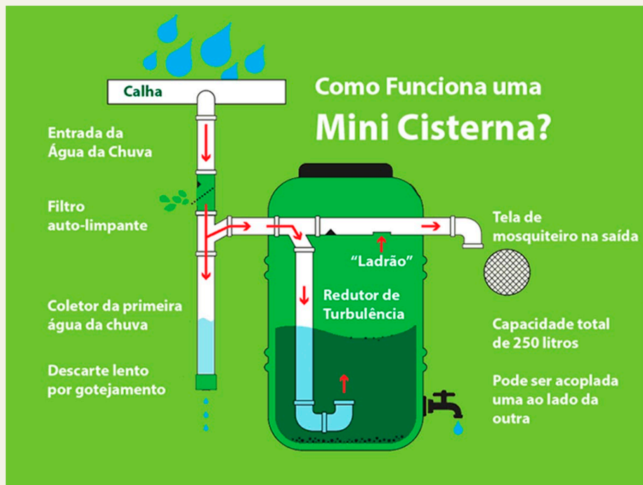
Figura 1 – Esquema simplificado de cisterna de água de chuva com bombona plástica
