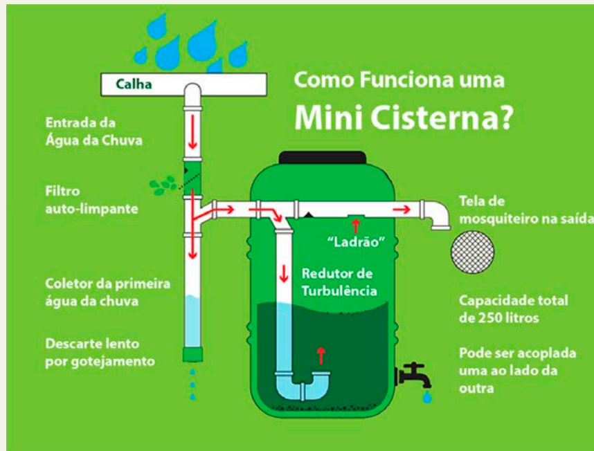
Figura 1 – Esquema simplificado de cisterna de água de chuva com bombona plástica
